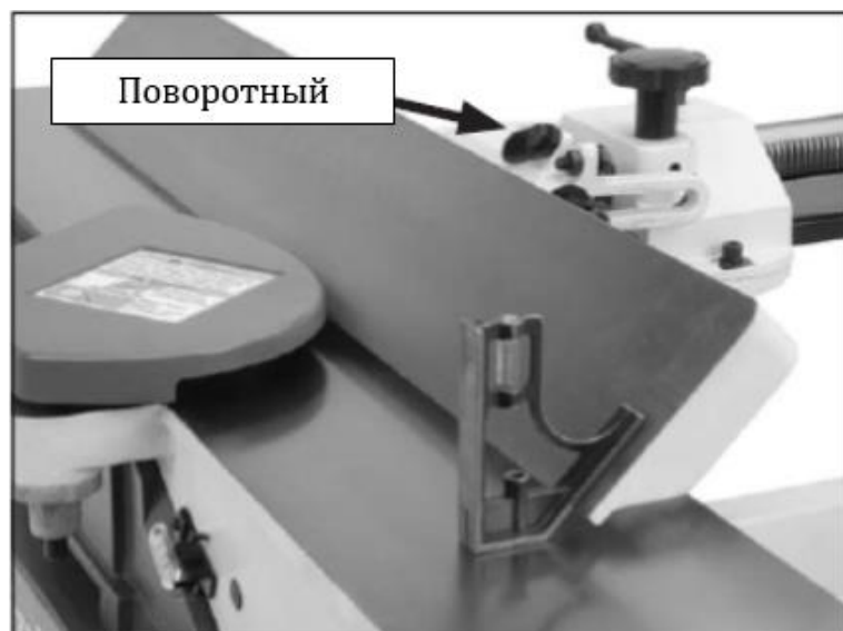
Рис. 28. Регулировка параллельного упора под углом 45° наружу
