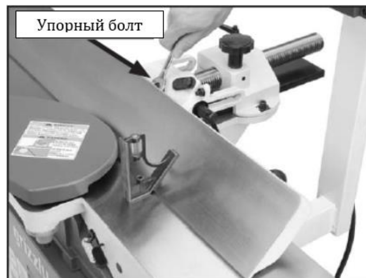
Рис. 29. Контргайка упора под углом 45° положения параллельного упора
