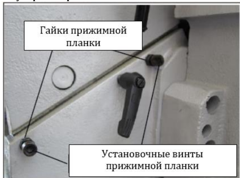
Рис. 30. Органы регулировки прижимных планок выводного стола
