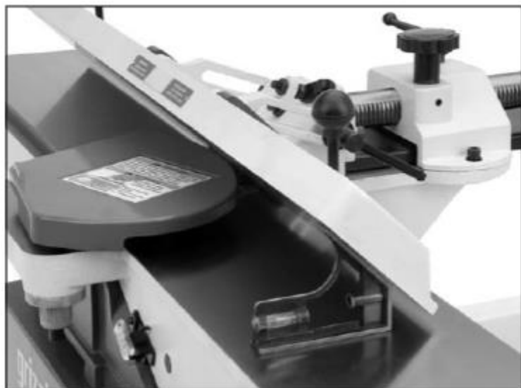
Рис. 24. Настройка под угол 45° внутрь
