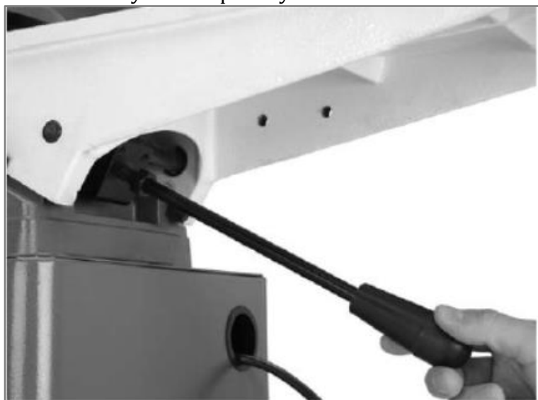
Рис. 16. Установка рычага подводного стола
