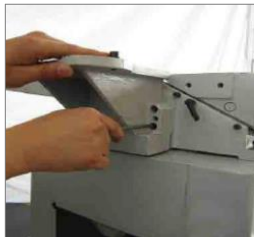
Рис. 9. Собранный кронштейн крепления каретки
